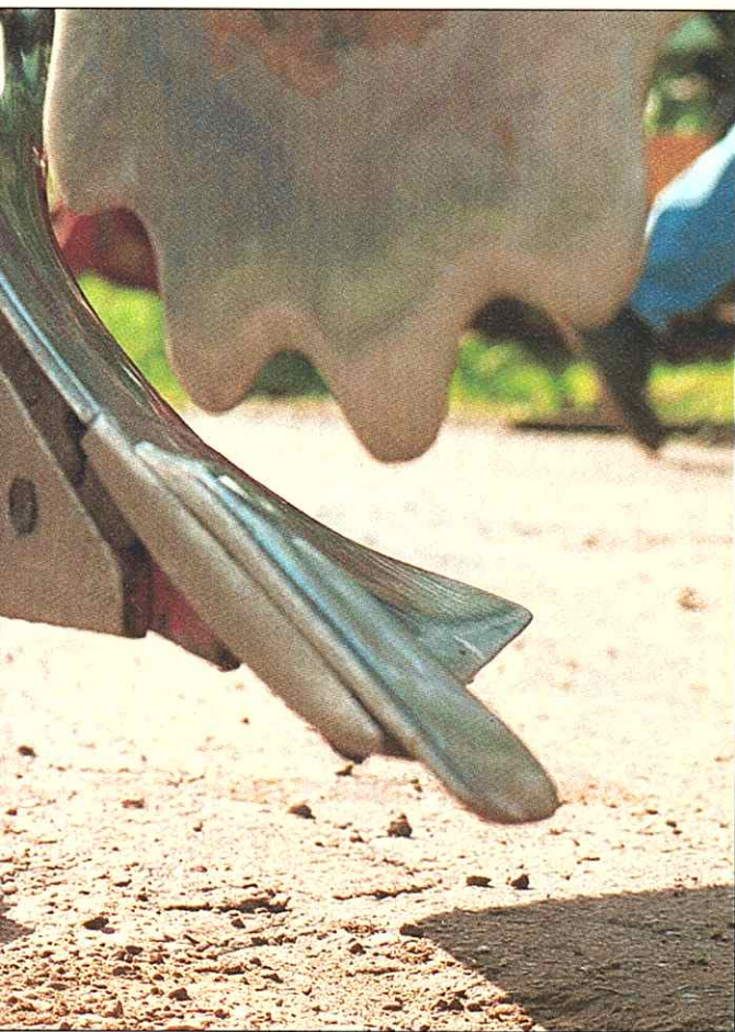
De Kverneland Eco-schaar maakt bij ondiep ploegen toch de ondergrond tot de 'normale' ploegdiepte los. Werkt 25 centimeter breed.
