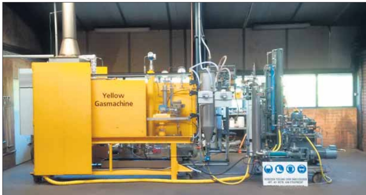
Het prototype van de Yellow Gasmachine in Raalte heeft een capaciteit van 200 liter per uur.
