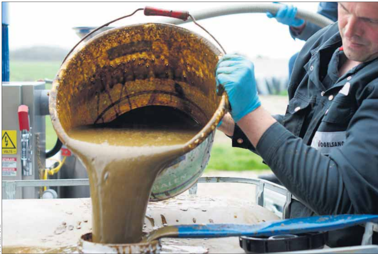
Vorbewerkte rundveemest voor de Yellow Gasmachine. Een goed lopend vergassingsproces vereist een egale, smeujige invoer.
